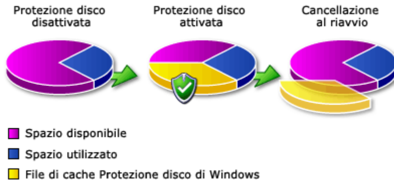
Figura 6: illustrazione dell'utilizzo del file di cache quando Protezione disco di Windows è attivata.
